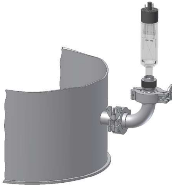
Схема подключения датчика ПМТ-2 к вакуумной системе
